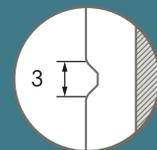
Prägung/Fräsung für Mala in Polarweiß in Millimetern
