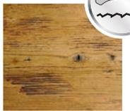
**Karbonisierte Oberfläche:** Durch kontrolliertes Beflammen entsteht eine Holzkohleschicht mit sehr interessanter und lebhafter Optik, die je nach Holzart unterschiedlich ausfällt.
