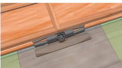
Die Schrauben erst anziehen, nachdem die nächste Dielenreihe eingeschoben wurde. Die letzte Reihe wird wieder mit Start-/End-Clips befestigt.
