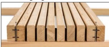
Wir empfehlen, jedes Element mindestens an den vier Ecken mit der Unterkonstruktion oder dem entsprechenden Untergrund zu verschrauben. Hierzu schieben Sie bitte die mitgelieferten schwarzen Beilagscheiben in die Nuten der zwei äußeren Lamellen. Jetzt können Sie wahlweise mit Fassadenschrauben 4,5 x 70 mm/4,5 x 80 mm/4,5 x 100 mm oder Terrassenschrauben 5 x 70 mm/5 x 80 mm/5 x 100 mm, z.B. von der Firma SPAX, die Befestigung vornehmen.
