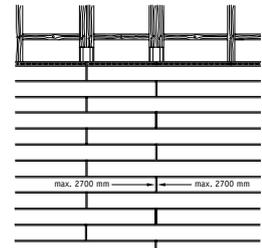
**3. Horizontale Verlegung im Schiffsverbund (selekta)**
