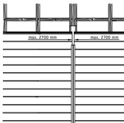
**4. Horizontale Verlegung mit vertikaler Fuge, mit Abdeckprofil verkleidet (selekta)**
