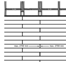
**3. Horizontale Verlegung im Schiffsverbund (selekta)**
