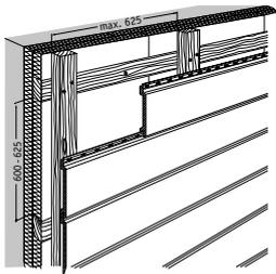
**1. Horizontale Verlegung V\_Selekta\_3 (selekta)**
