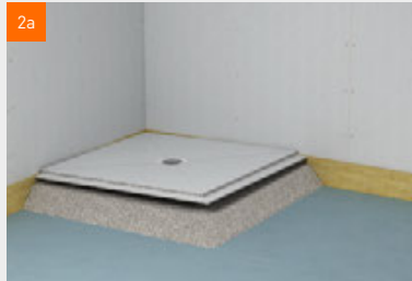
Variante A: In der Höhe der Oberkante des Ablaufgehäuses wird im Bereich des Duschelements ein fermacell™ gebundenes Schüttungsprodukt abgezogen und das Duschelement gesetzt
