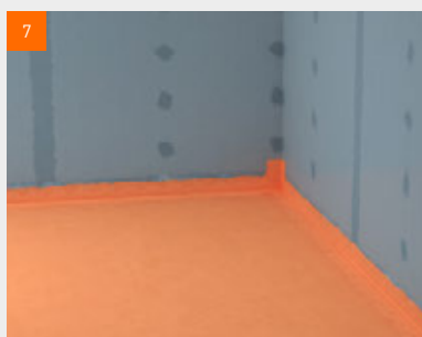
Bei der Verwendung von Gipsfaser Estrich-Elementen in Klasse W1-I muss zusätzlich eine vollflächige Abdichtung erfolgen. fermacell™ Flüssigfolie mit der Rolle mind. 2 x vollflächig auftragen (Trockenschichtdicke mindestens 0,5 mm). Gemäß DIN 18534-3 wird für den 2. Auftrag ein Farbunterschied zur besseren Nachvollziehbarkeit gefordert. 1. Auftrag: fermacell™ Flüssigfolie in Originalfarbe satt auftragen und trocknen lassen.
