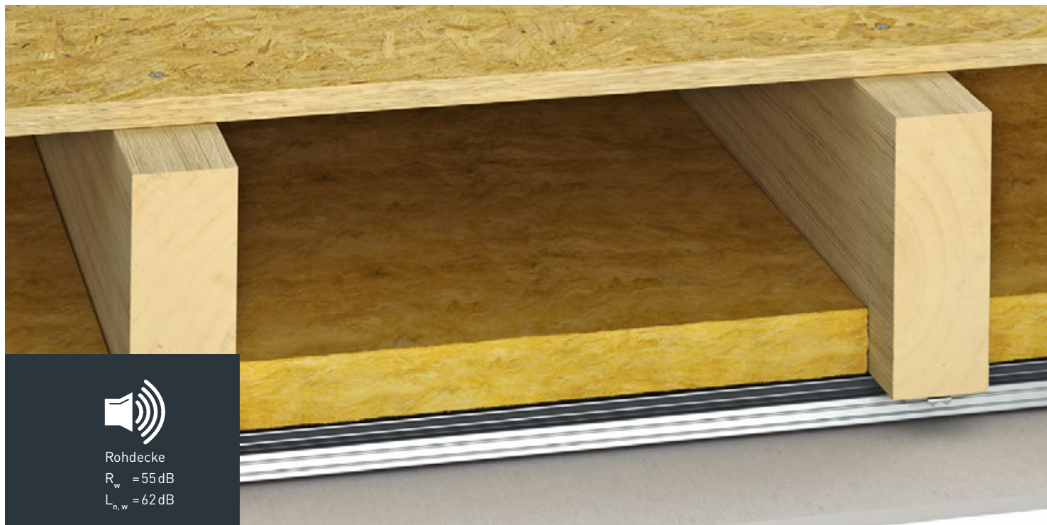
Geschlossene Holzbalkendecke, Unterdecke federnd abgehängt
