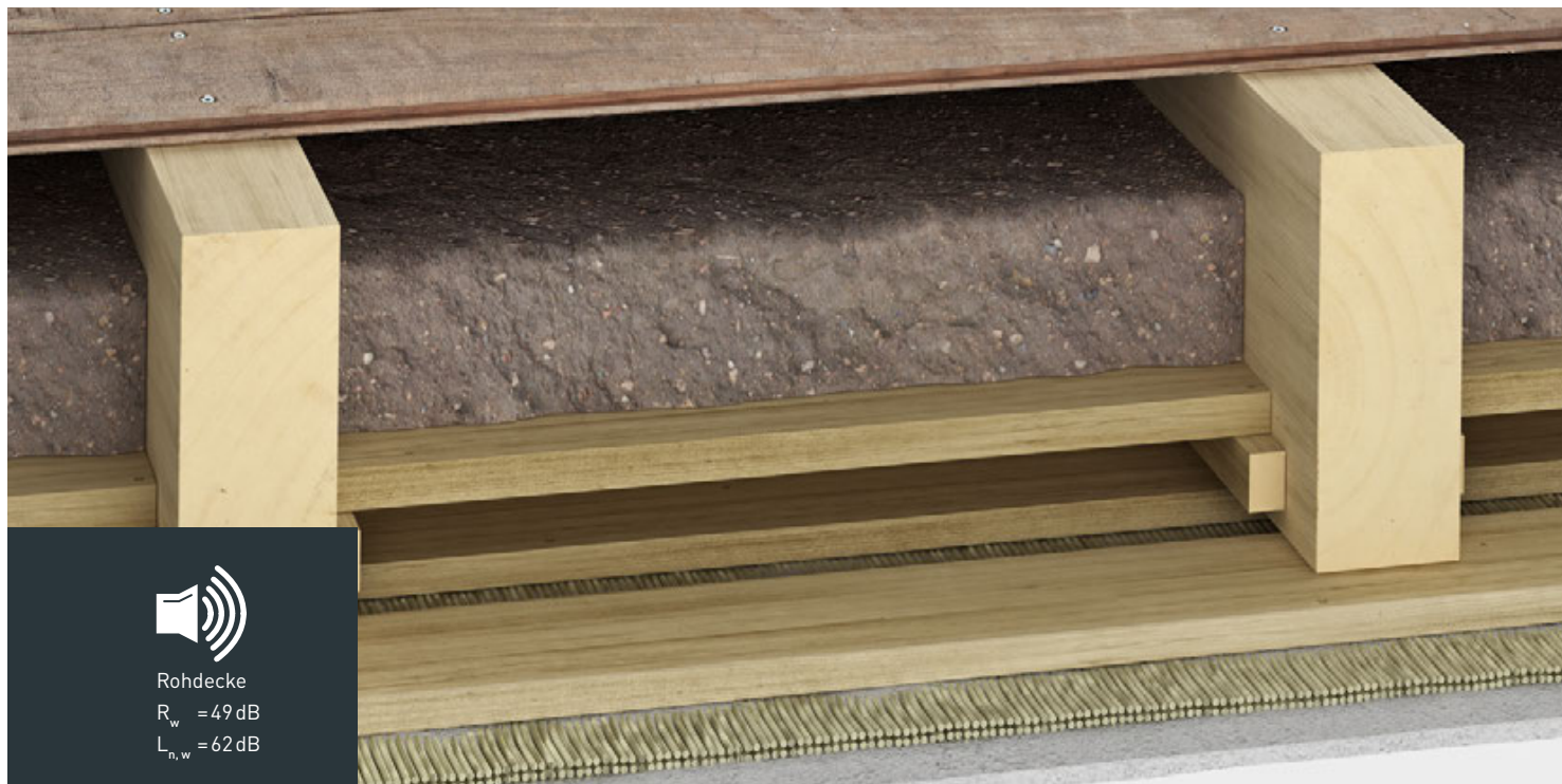
Geschlossene Holzbalkendecke, Einschub nicht tragend
